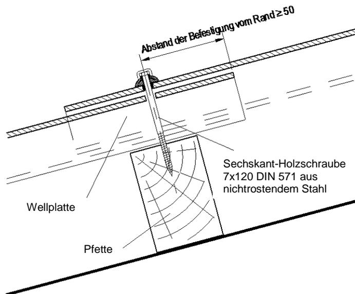
Bild 6: Anordnung der Befestigungen bei Holzpfetten
