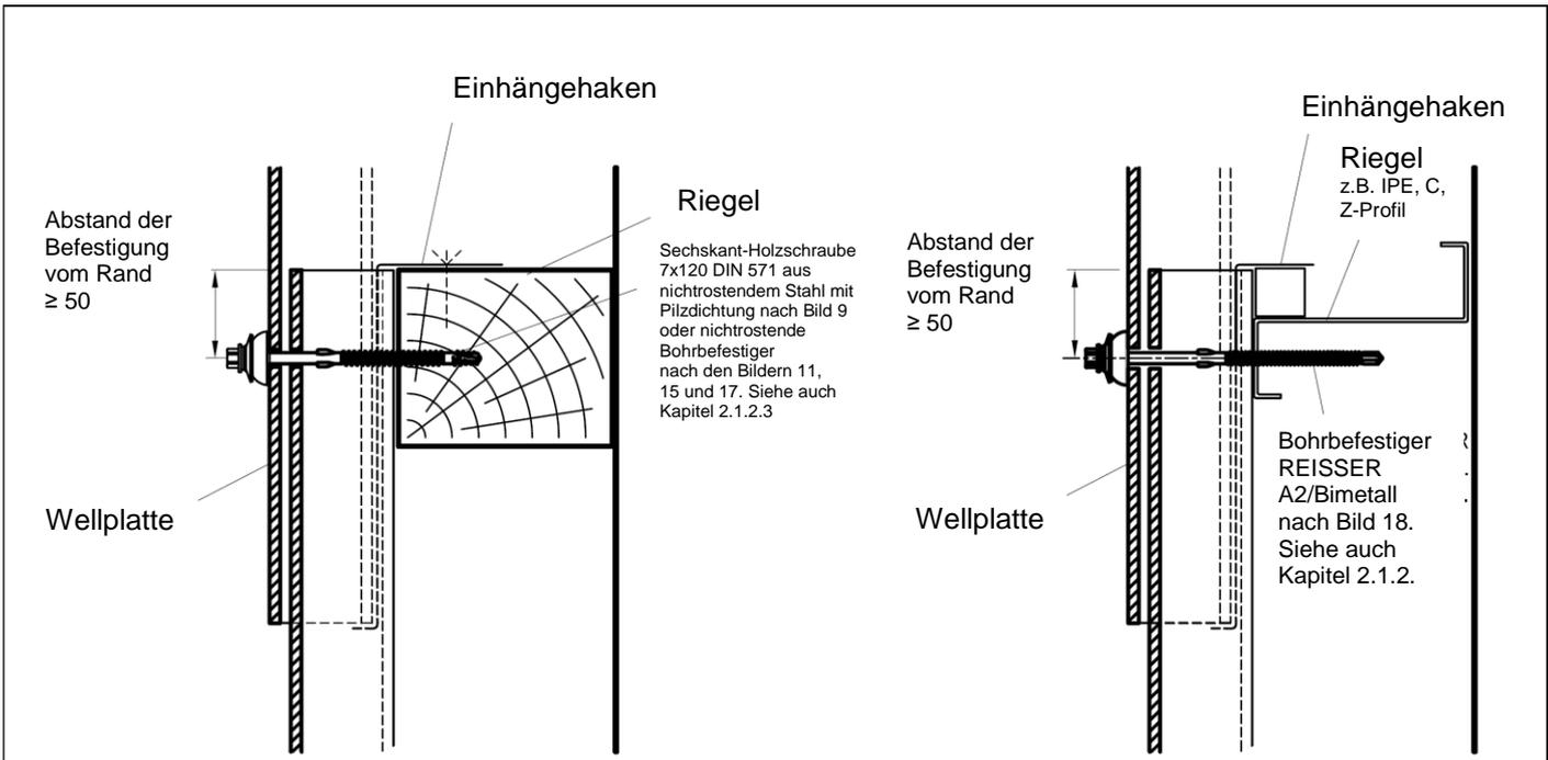
Bild 17a: Anordnung der Befestigungen auf dem Wellenberg bei Holz-UK
