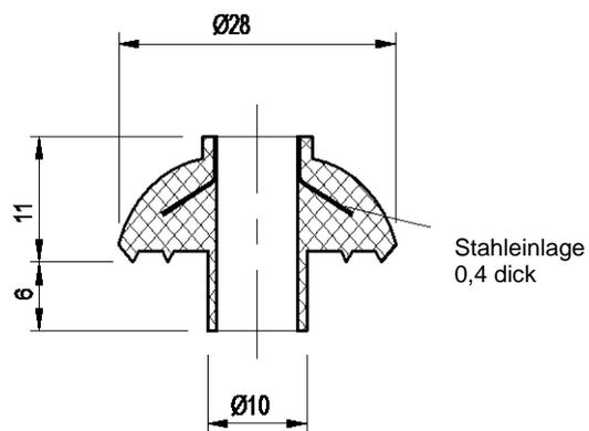
Bild 7: Pilzdichtung
