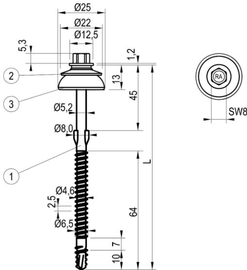
Bild 15: REISSER WFBS-V-A Ø 6,5 x L
