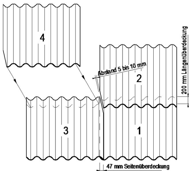
Bild 4: Überdeckungen und Eckenschnitte der Platte **P5** und **P6**
