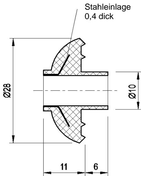
Bild 18: Pilzdichtung
