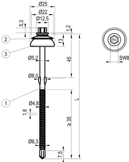
Bild 16: REISSER A2/Bimetal WFBS-B-Z6
