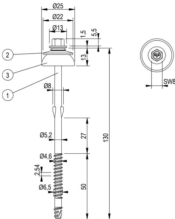
Bild 11: SFS SCFW-BAZ 6,5 x 130 für Holzunterkonstruktion
