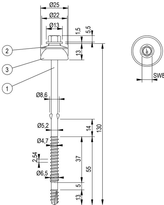
Bild 10: ETANCO Monovis 6,5 x 130 für Holzunterkonstruktion
