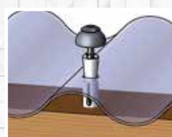
3. Beim Einschrauben in die Unterkonstruktion muss der Hülsenbund unter der Poriltafel liegen, damit sie sich aufspreizen kann
