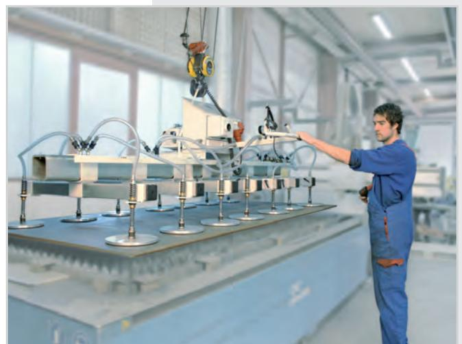
Vakuumheber mit Gebläse werden bei kleinen bis mittleren Lasten eingesetzt.
