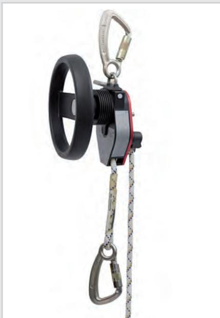
Das **MILAN HUB AGR 2001** ist das Standard-Rettungsgerät mit Hubfunktion. So ist es möglich, einen Verunfallten erst über eine kurze Strecke anzuheben, um sein Verbindungsmittel zu lösen und ihn dann sicher abzuseilen.
