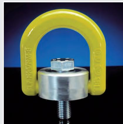
\* Die Tragfähigkeit ist möglich, wenn die Belastung gemäß Abbildung axial zum Gewinde steht. Eine radiale Belastung/Biegung muss hierbei grundsätzlich ausgeschlossen werden!
