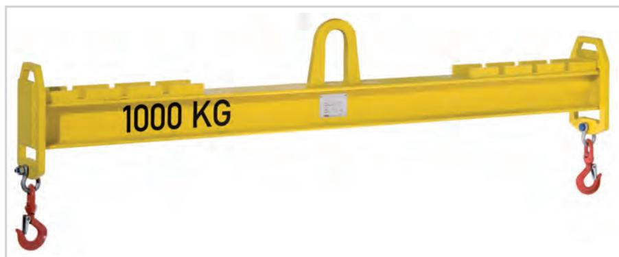
Der **Typ STV** ist gebaut als Schweißkonstruktion aus Formstahl mit zwei Laschen und drehbaren Lasthaken nach DIN EN 13155 im verstellbaren Abstand. Axial werden die Laschen formschlüssig gesichert. Die Laschen haben eine Transportöse für die Verstellung.
