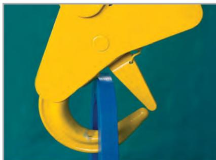
Der Sicherheitslasthaken bleibt auch im entlasteten Zustand gesichert.
